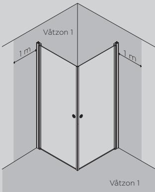
**SE** Skruvinfästningar i våtzon 1 ska göras i betong eller annan massiv konstruktion (a), träreglar, träkortlingar (b) eller i konstruktion som är provad och godkänd för infästning, till exempel skivkonstruktion (c). Se exempel på godkända konstruktioner på säkervatten.se.
